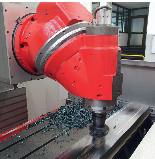
3 Eine Ecomill Plus mit selbstentwickeltem Fräskopf bei einem Testlauf im Zuge der Montage © Hanser
